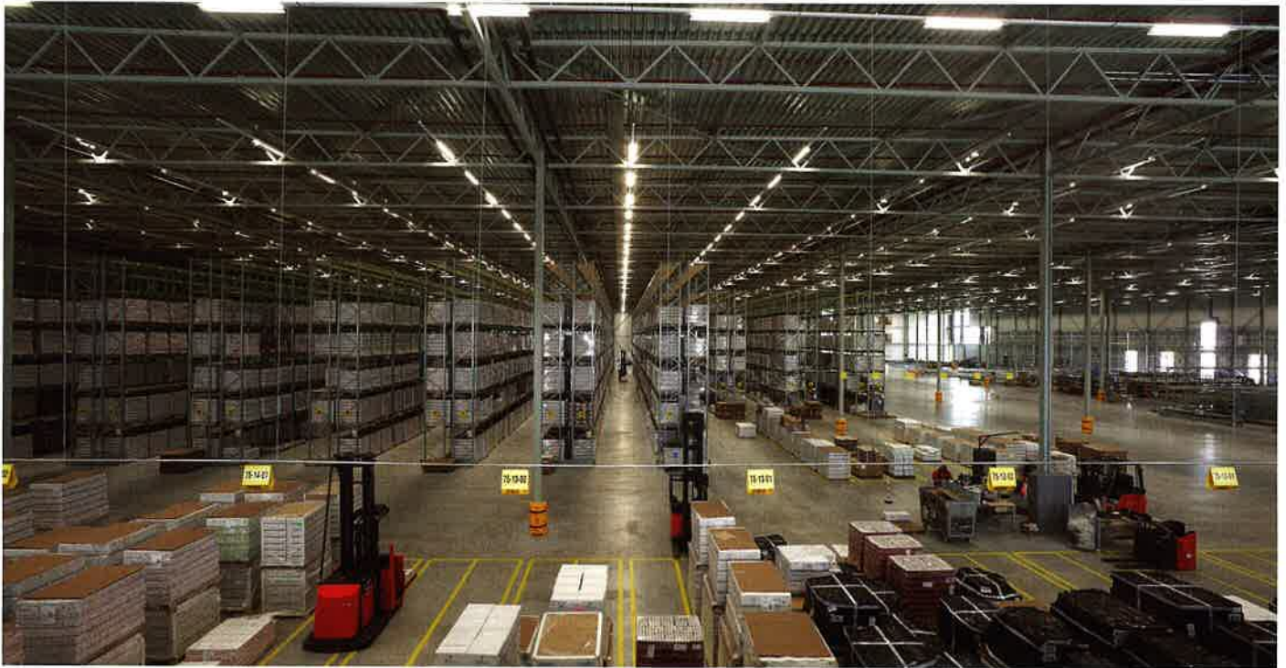
Ongeveer de helft van het nieuwe magazijn is gereserveerd voor de bulkvoorraad. In de palletstellingen is plaats voor 8.500 locaties. Vanuit dit gedeelte wordt in de eerste plaats de voorraad in de lokale magazijnen aangevuld.
